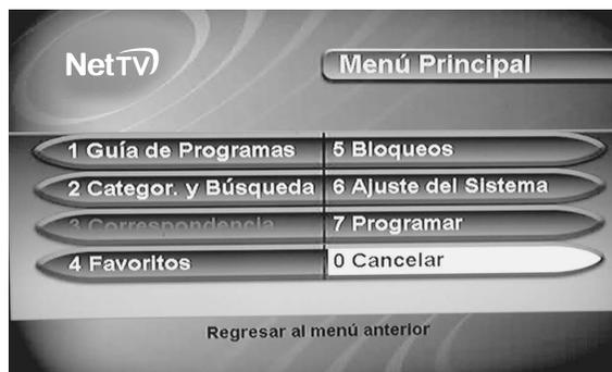
Para seleccionar cada uno de los submenús del Menú Principal, utilice su control remoto, presione los botones ARRIBA-ABAJO o IZQUIERDA-DERECHA y el botón **SELECT** para entrar al submenú o puede seleccionarlo desde el panel numérico de su control remoto presionando el número asignado a cada submenú.
